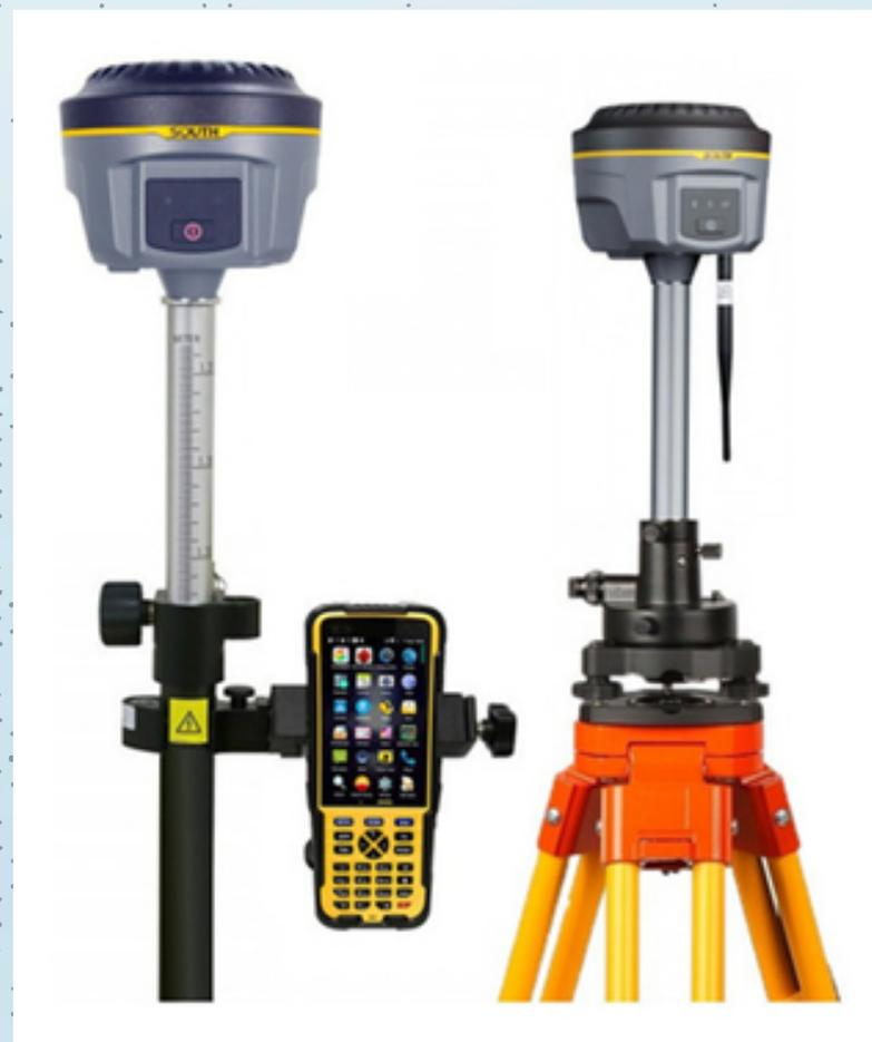
El Galaxy G6 es un receptor GNSS multifrecuencia que admite señales de los sistemas GPS, GLONASS, Galileo y BeiDou, lo que mejora la cobertura y precisión del posicionamiento. Se utiliza para levantamientos en tiempo real con **tecnología RTK (Real-Time Kinematic)**, proporcionando coordenadas precisas.
